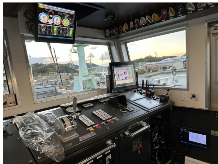
図 2.2 操舵席に設置した監視モニタ
