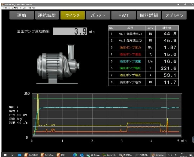
(a) 油圧ポンプの監視画面
