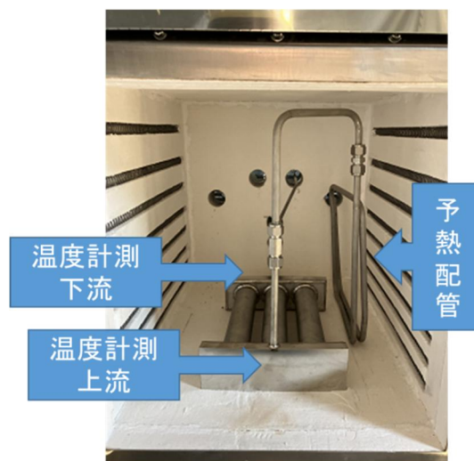
図 5-7 電気炉内にニッケル系ハニカム用改質容器をセットした様子
