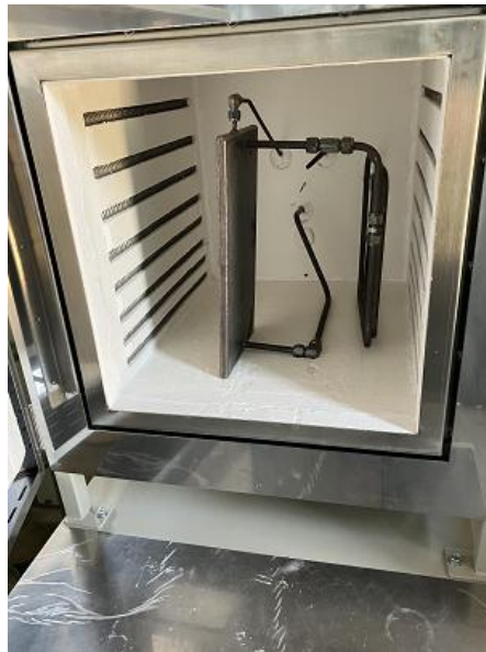
図 5-11 電気炉内にルテニウム系ペレット触媒改質容器をセットした様子
