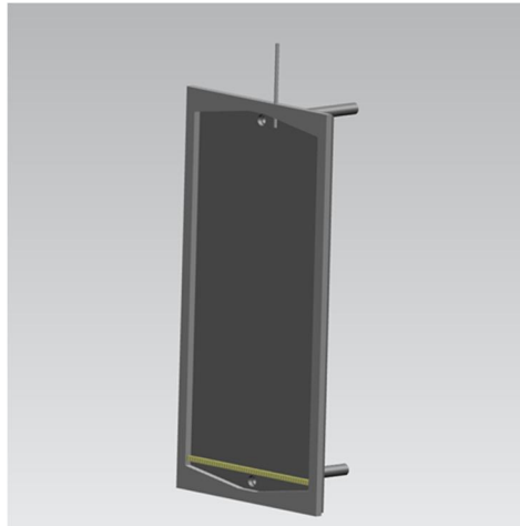
図 5-2 ペレット用改質容器。(上蓋を外した状態)
