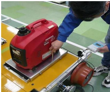
図 2.3-7 振動測定状況
