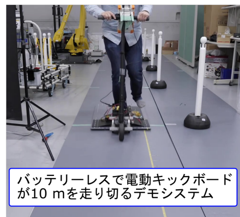
図4：6.78 MHz を活用した 10 m 規模のワイヤレス充電システム.
