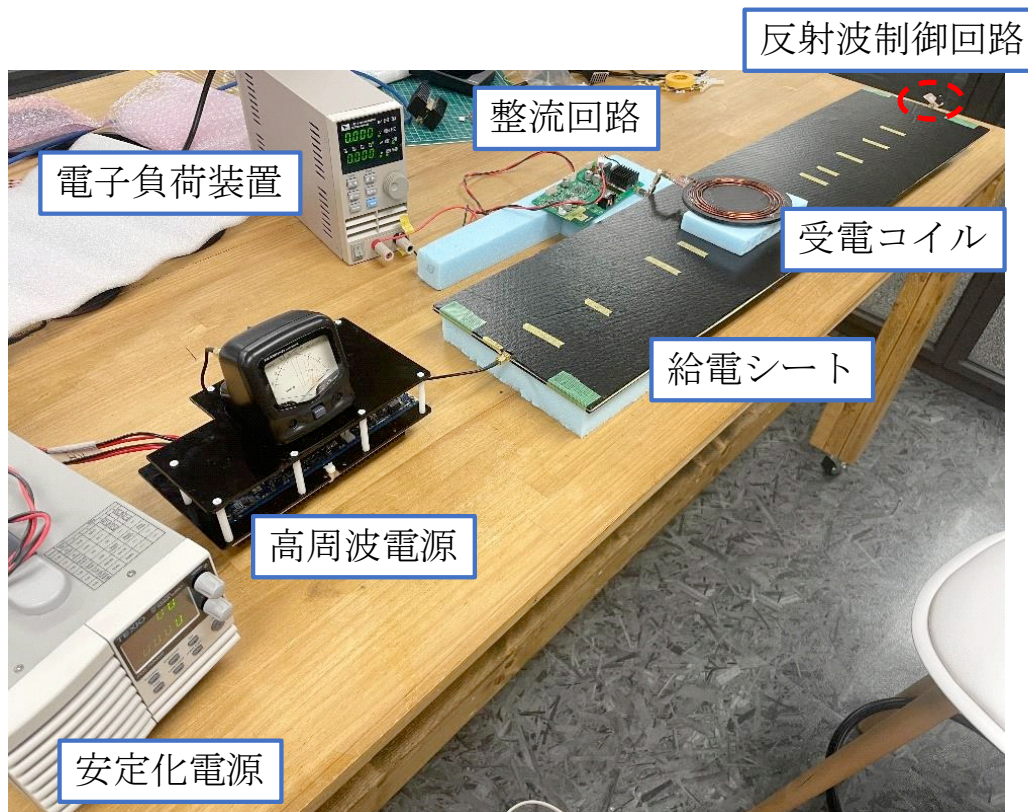
図 14 : 試作ワイヤレス給電システムの給電実験環境
