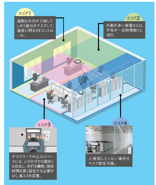
画像センサー方式の概要 (提供：三菱電機株式会社)
