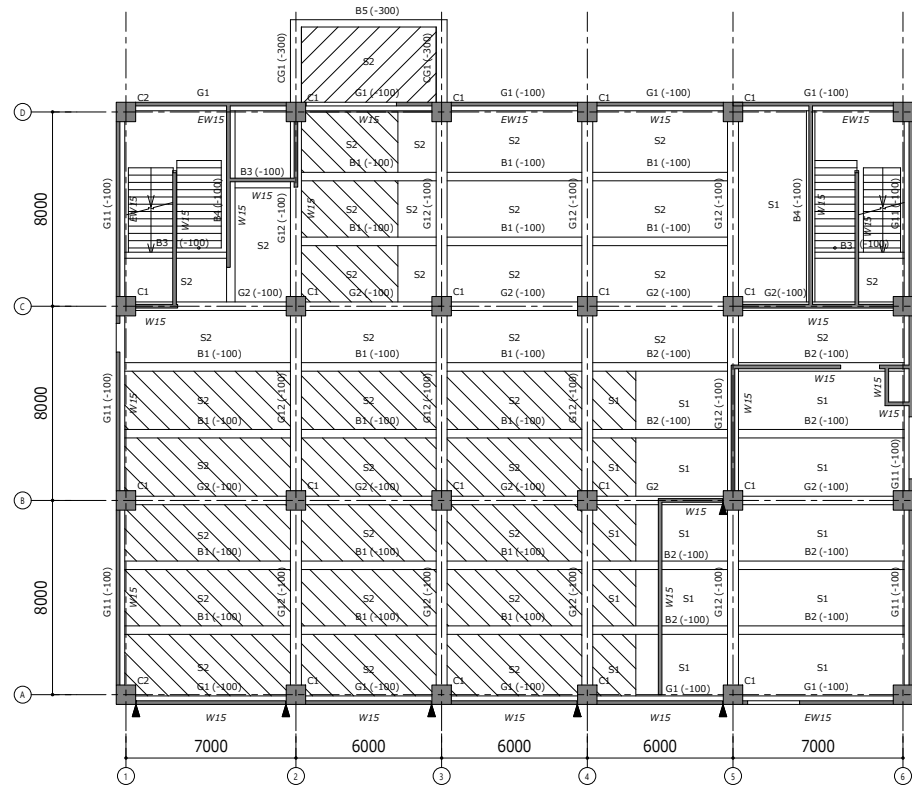
【1】1階柱壁、2階床梁伏図 見上 1:200
