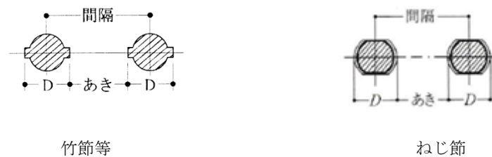
図 8.3.5 鉄筋相互のあき及び間隔
