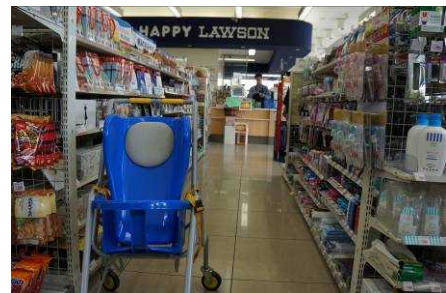
ベビーカー、車椅子を考慮した通路幅：ベビーカー、車椅子、買物用カート等の利用時人も人とすれ違える1,200mm以上の通路幅
