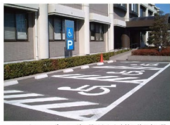
・エントランスポーチの端に設けられた車椅子使用者用駐車施設（ポーチまでスロープを設けている。）
