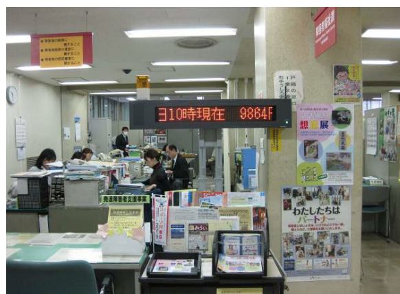
・区役所の受付カウンターに設けたLED電光表示板（通常はニュース等をスクロール表示しているが、緊急地震速報発表時は「緊急地震速報」と点滅表示する。）
