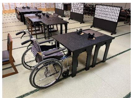
■ 車いすの手すりが収まらないテーブルの高さ
