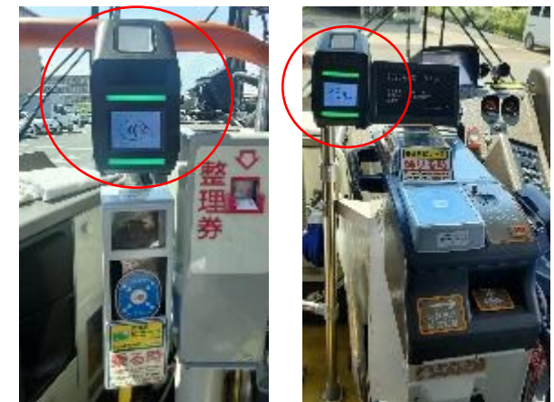
▼実際に設置した機器
