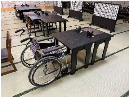
■ 車いすの手すりが取まらないテーブルの高さ
