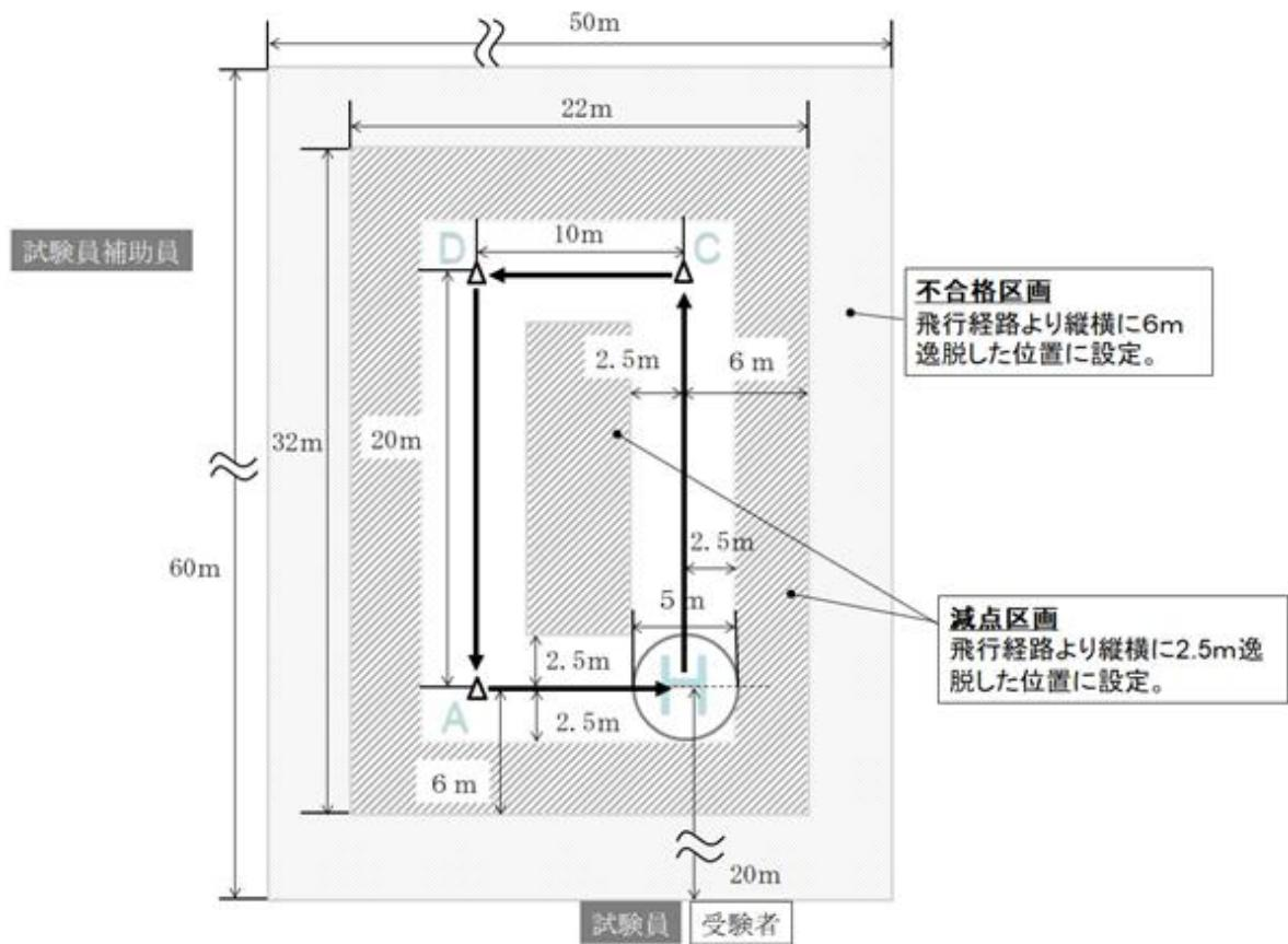
※1：試験員と受験者は横方向に移動し、HからC間及びDからA間での機体の位置を確認することができる。
