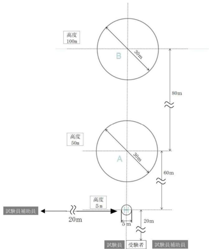
※ 1 : 試験員補助員は機体の高度を確認し、読み上げること。
