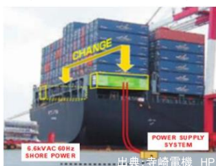
停泊中船舶への陸上電力供給
