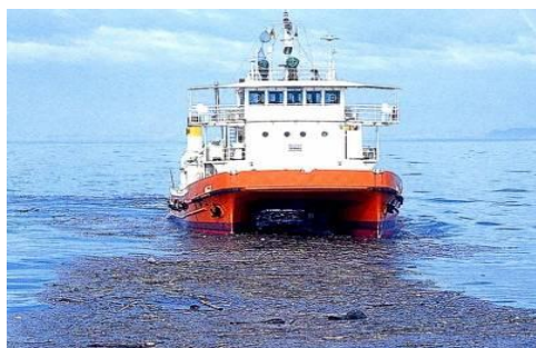
海洋環境整備船による 閉鎖性海域での漂流ゴミの回収
