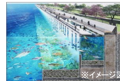
【生物共生型港湾構造物】
