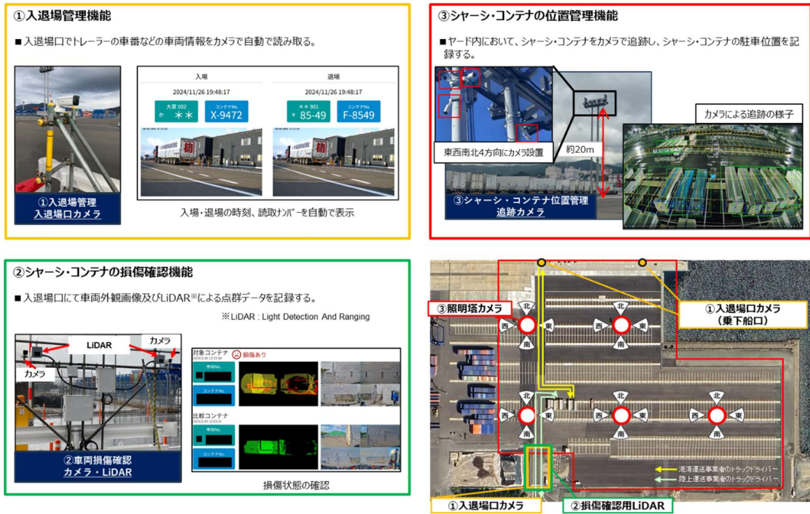
図 4-3 カメラによる撮影技術を用いたシャーシ・コンテナ位置管理等システムの施設配置例
