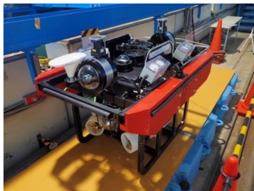
写真-1 栈橋上部工点検用ROV
