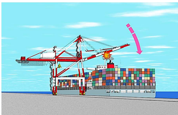
クレーンと船橋との衝突(起伏時)
