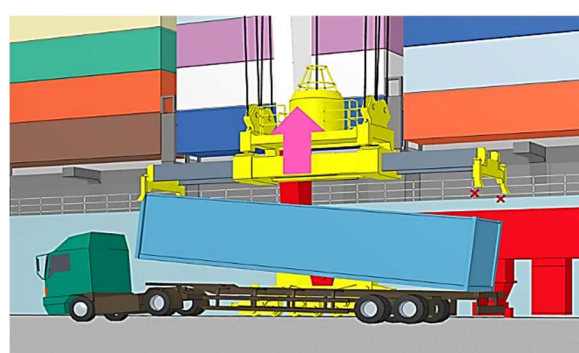
コンテナの片吊り
