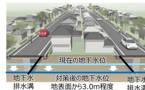
液状化対策のイメージ (地下水位低下工法)
