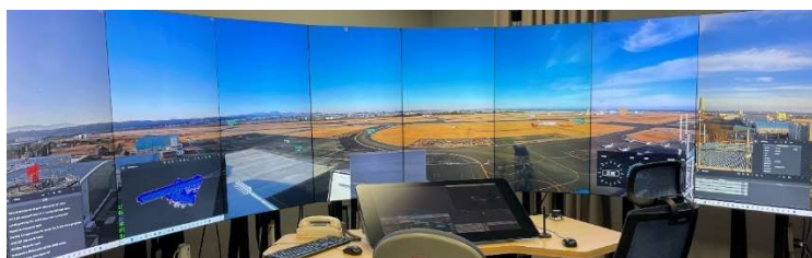
図 1.4.40 管制官業務への情報レイアウトの HMI 最適化設計例(機能の操作性と業務分析に基づいたルックダウン抑制に効果的な情報レイアウトのプロトタイプ)
