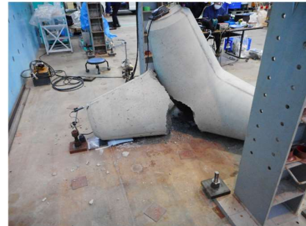
図 1.3.2b-6 消波ブロックの載荷試験
