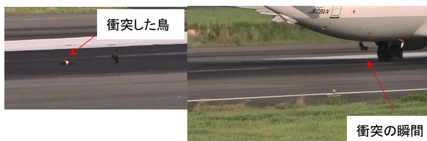
図 1.4.46 自動検知したバードストライクの状況(2023 年 9 月 27 日)
