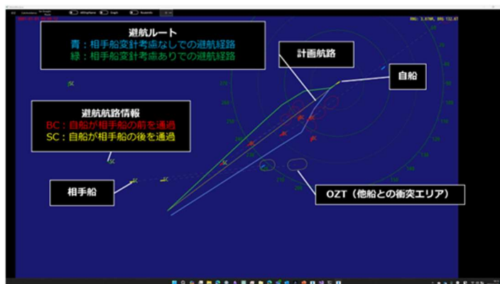
図 1.2.65 避航操船システム
