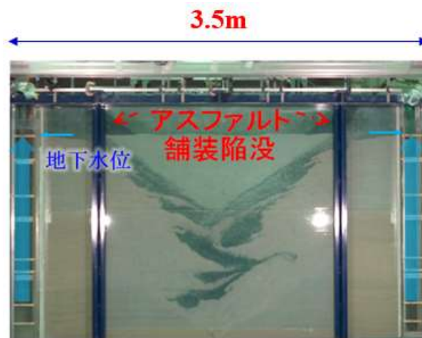
図 1.3.1a-7 臨海部の舗装直下地盤の陥没後の状況: 実大試験結果
