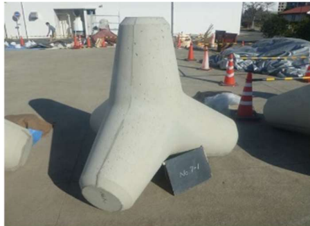
図 1.3.2b-5 低炭素コンクリートで作製した 2t 消波ブロック
