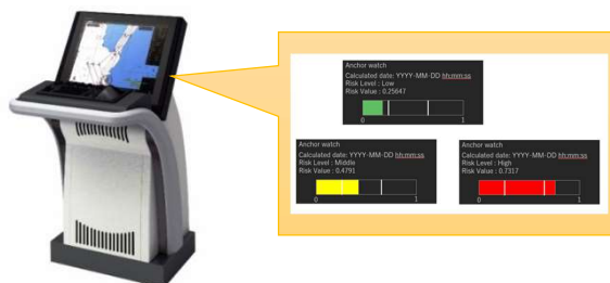
図 1.2.51 振れ回り運動の数値シミュレーション結果を ECDIS 上に表示する画面
