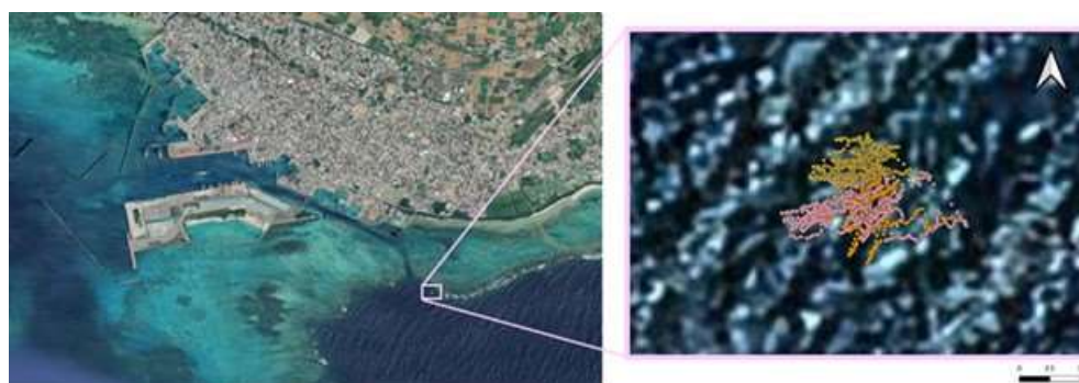
図 1.2.131 石垣島南海域での観測対象イシサンゴ調査時の ASV 海上位置 (ASV 水中カメラによる AUV 監視時、橙色:1/23、桃色:1/24 午前、黄色:1/24 午後)
