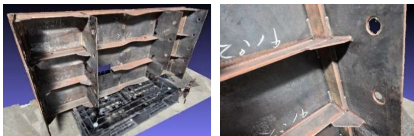
全体 右端部の拡大 図 1.2.1 試験体サイズ(2m程度)での3D 形状生成結果
