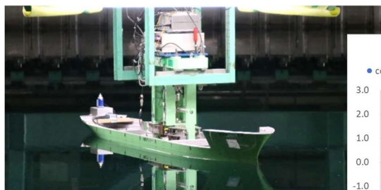
図 1.2.49 内航タンカー模型 の操縦流体力の計測
