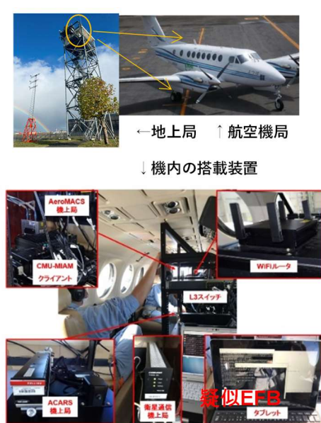
図 1.4.56 飛行試験で用いたマルチリンク実証システム
