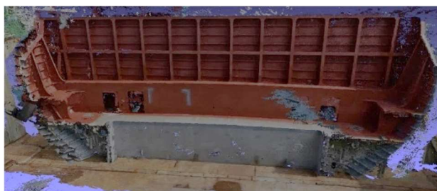
図 1.2.3 実船スケールの3D 形状生成結果
