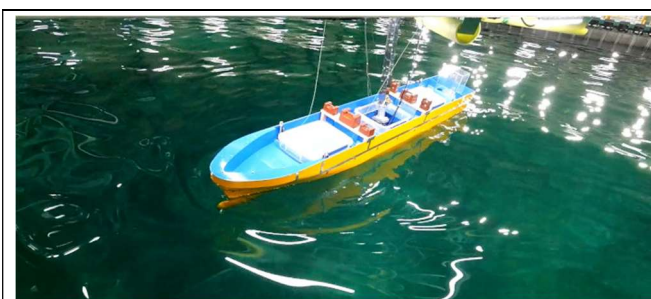
図 1.2.47 コンテナ船不規則中パラメトリック横揺れ試験
