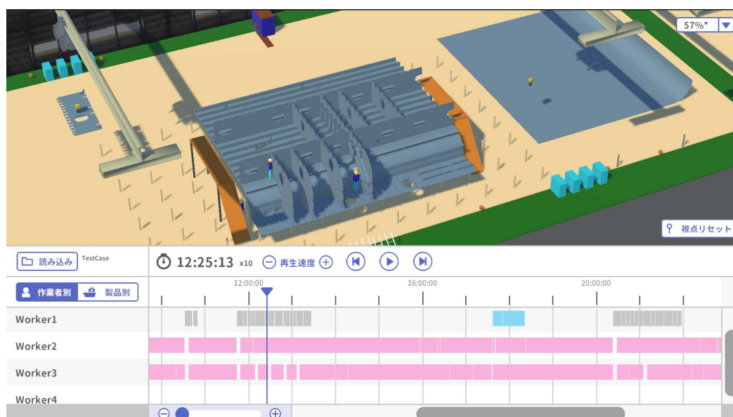
図 1.2.145 3D とガントチャートの可視化ツール(浅川造船株式会社様 データご提供)
