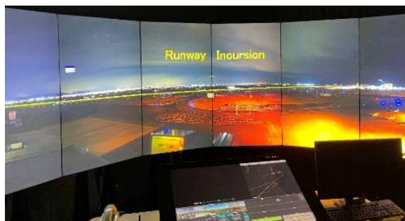
図 1.4.38 試験システムにおける RWI のデモ表示例
