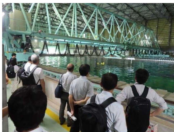
図 I .5.(4).②.1 浮体式風車の不規則波中の水槽試験に関する公開実験(令和6年9月)
