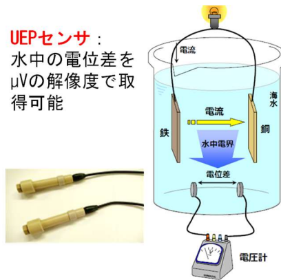
図 I.3.(4).②.4 UEP センサ(海中電界センサ)の概念図
