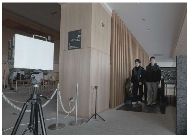
図 I.5.(3).②.1 3次元レーダーイメージャとエスカレーターを流れる人流の撮影例(左)および撮影された人物の3次元レーダーイメージの表示例(右)
