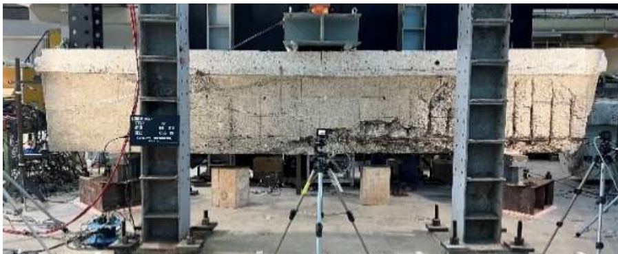
図 I .3.(3).②.7 実部材(栈橋から切り出した梁)の載荷試験状況
