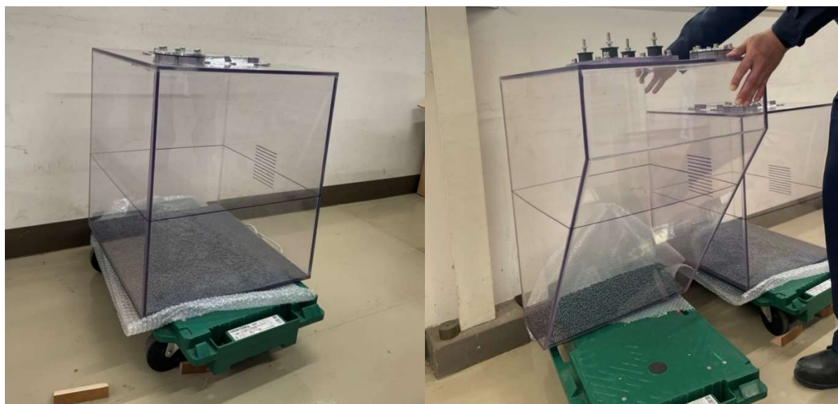
図 I . 2. (3). ①. 11 波に対する指向性を有しない浮体(左図)及び指向性を有する浮体(右図)
