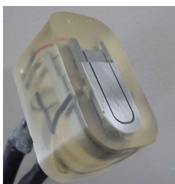
図 I. 2. (1). ①. 8 試作腐食進行検知センサ
