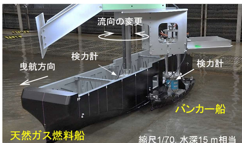
(a) 2船体拘束曳航試験の様子
