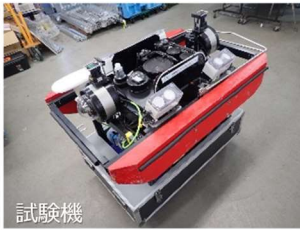
試験機 (L1200 x W800, 100kg) への実装と特定動作の自動化実験 (四日市港)
