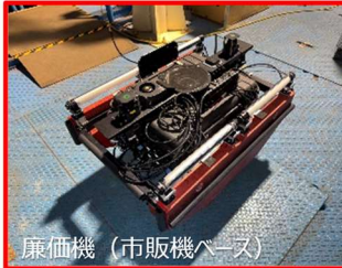
廉価機 (L800 x W600, 50kg) への実装と特定動作の自動化実験 (水槽)
