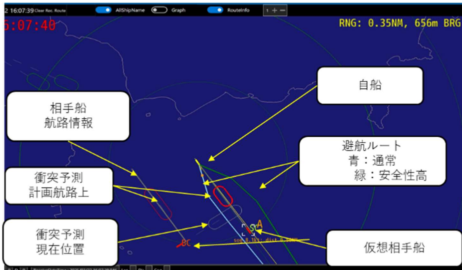
図 I . 2. (1). ①. 36 実船試験時の避航操船システム画面と海図表示 (仮想相手船の航路情報を受信し、衝突予測位置を相手船の航路情報に基づいて算出し、避航ルートを生 成している)
