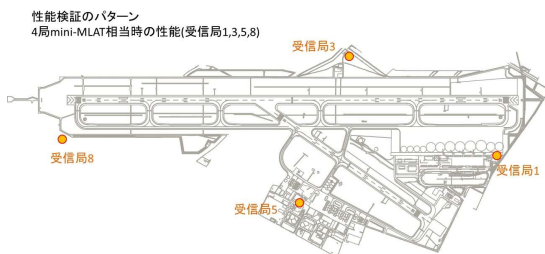
図 I . 4. (3). ①. 5 仙台空港での MiniMLAT の実験局
