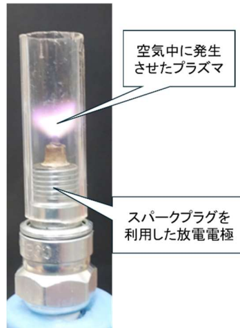
図 I . 2. (2). ①. 4 改良スパークプラグを用いた 13.56MHz の高周波プラズマ
