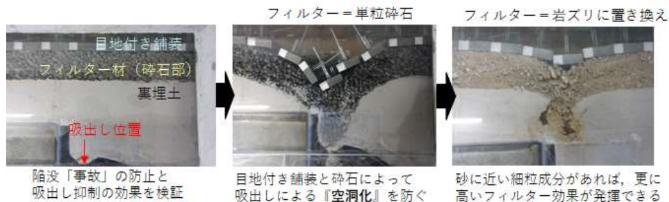
図 I.3.(1).②.3 新たな吸出し防止工(捨石置換工法)の実験例
