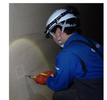
テストハンマーによる打音調査
