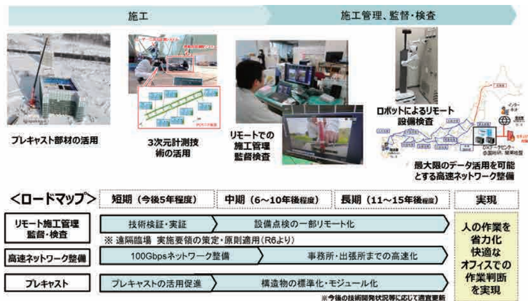
図表 I-2-1-19 施工管理のオートメーション化のイメージ及びロードマップ（2024.4）
