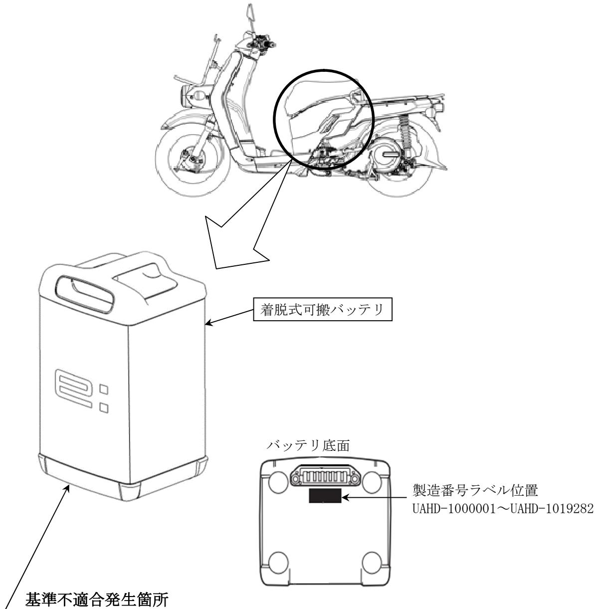
電動二輪車に搭載する着脱式可搬バッテリにおいて、バッテリ内のセルと構成する部品の溶接条件が不適切なため、損傷したセルから電解液が漏れることがある。そのため、そのまま使用を続けると、漏れた電解液により金属が析出し短絡して、セルが発火し火災に至るおそれがある。
