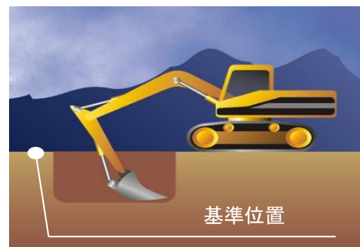
高さのわかる点からのオフセット施工
