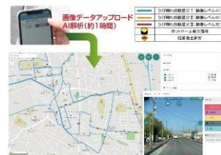
スマートフォンで取得した画像 と加速度による路面性状測定
