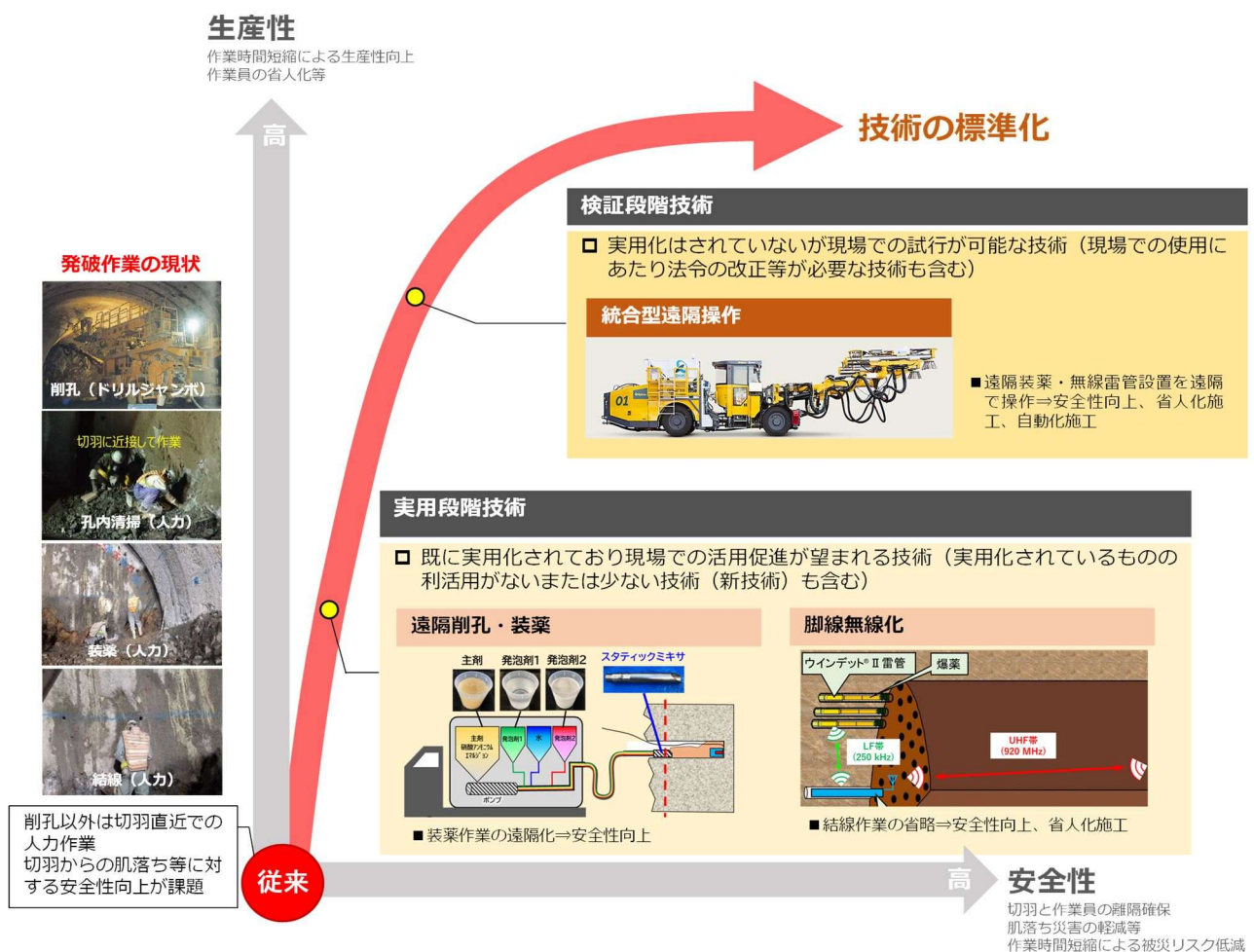
図-2.2 発破作業の自動化・遠隔化のロードマップ
