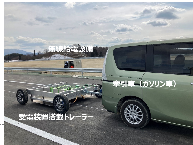
図3 停車中無線給電の実験イメージ
