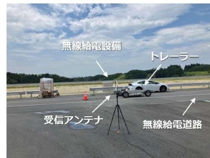
図6 漏えい電磁界測定の実験イメージ
