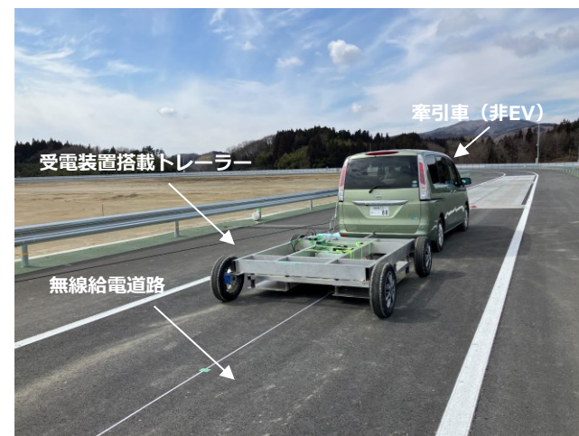
図2 走行中無線給電の実験イメージ
