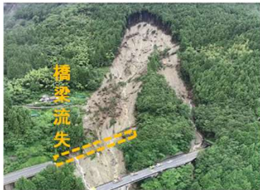
区域外の土砂崩壊による橋梁上部工流出
