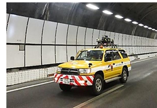
トンネル覆工コンクリートのひび割れの 進行状況を把握
