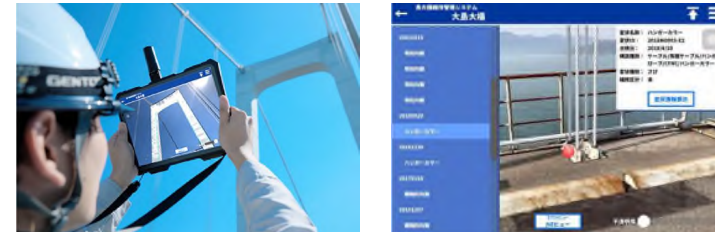
BIM/CIMモデルとMR技術を活用した長大橋点検支援ツール(開発中)
