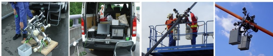
自走式斜材点検装置・地上制御部の構築
