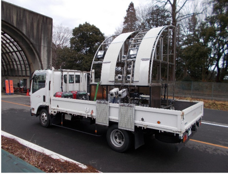
道路トンネル撮影状況
