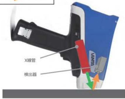
分析時のX線照射・蛍光X線検出イメージ
