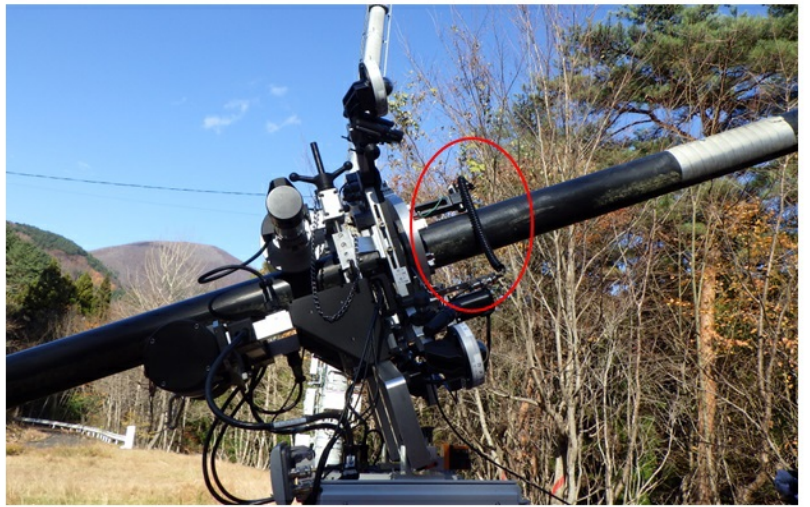
検査センサー(渦流探傷試験)可動状況
