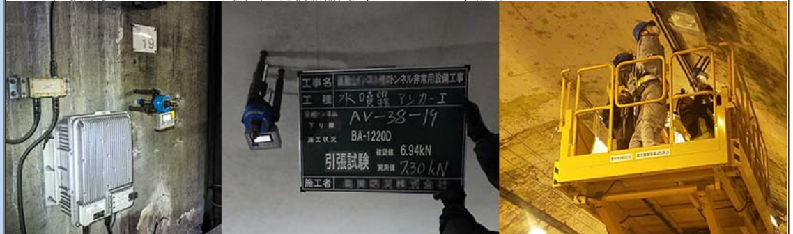
試験対象のアンカーボルトの取付物: 通信機器固定/ スプリンクラー/ 照明
