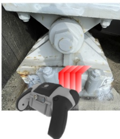
図2 計測対象面にパターン光を投影し、計測実施 (夏季1回、冬季1回)
