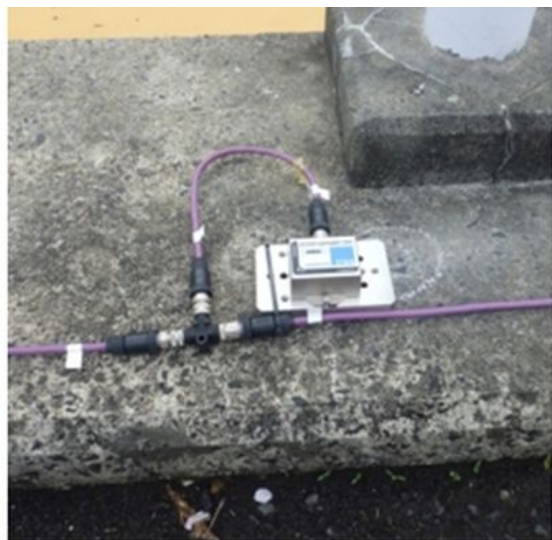
図面 3. 3 軸加速度計の設置例 (拡大図)
