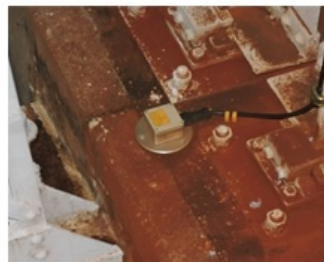
写真6.3 加速度センサの設置(1)
