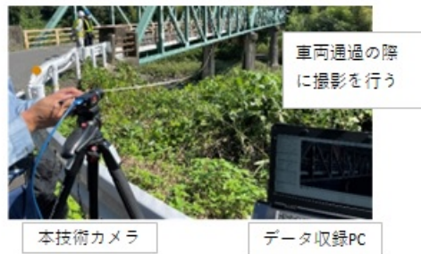
図2 本技術を用いた桁たわみ測定イメージ
