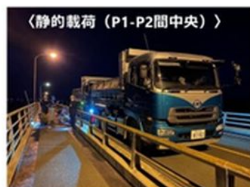
c) 静的載荷試験の様子
