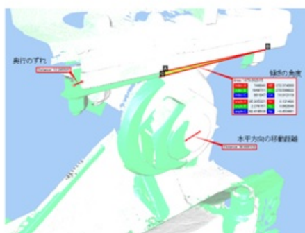
図5 可動部の夏季・冬季の角度のずれを求める
