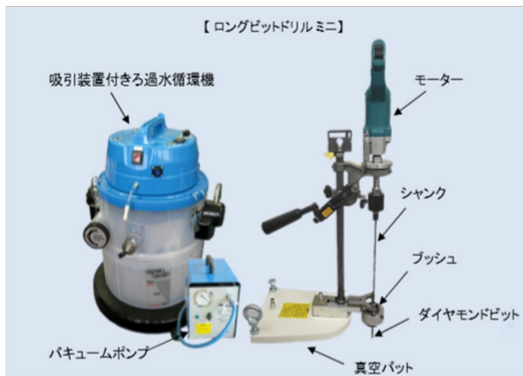
使用機材 (削孔装置)
