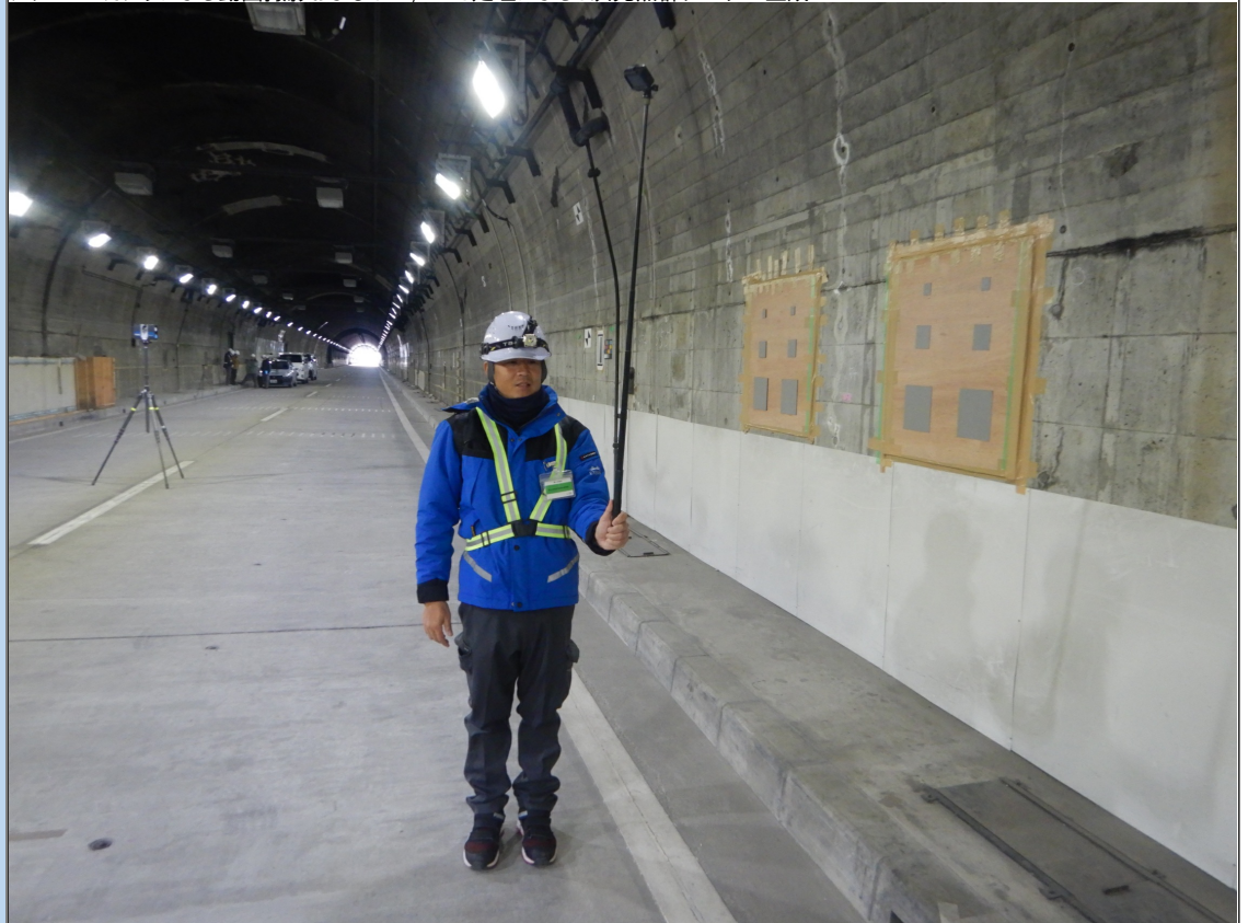
アクションカメラによる動画撮影およびSfM/MVS処理による3次元点群データの生成
