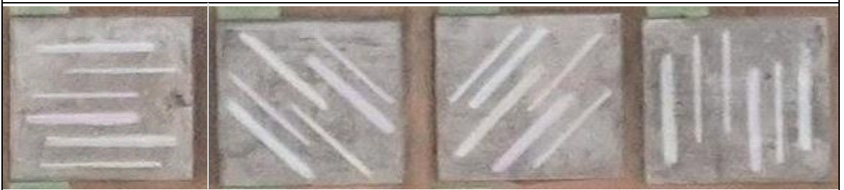
ひび割れパネル（マーキング供試体）
