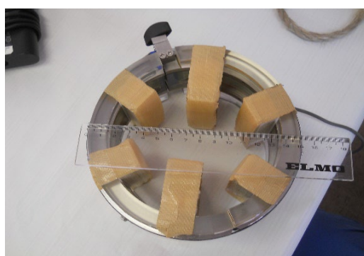
写真-11: センサ(直径150mm)
