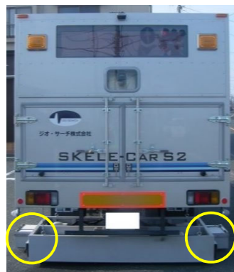
(写真-5) レーダ張り出し時
