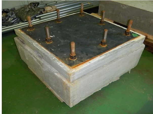
M24～M36アンカーボルトモックアップ試験体
