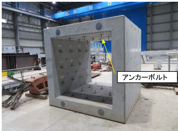
写真-2 RCボックスカルバート(EF-2) ボルト数31箇所 ボルト数 合計63箇所
