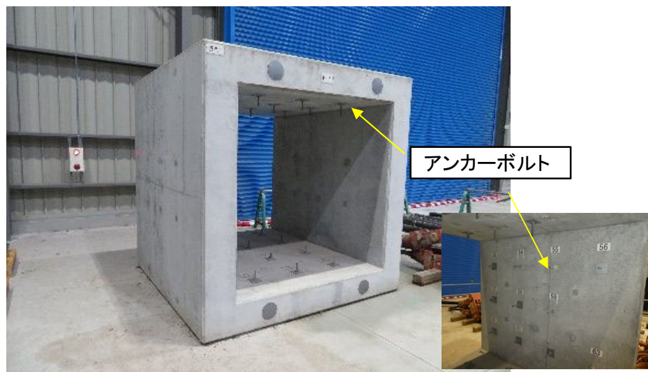
写真-1 RCボックスカルバート(EF-1) ボルト数32箇所
