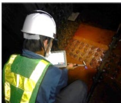
効力ボルトの遅れ破壊の検出状況
