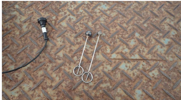
写真-6: 加速度計と起振用鋼球
