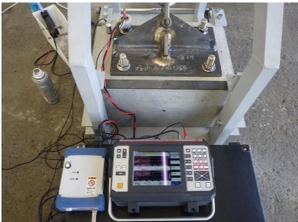
写真-2 電磁パルス法によるボルト緩みの検出の状況
