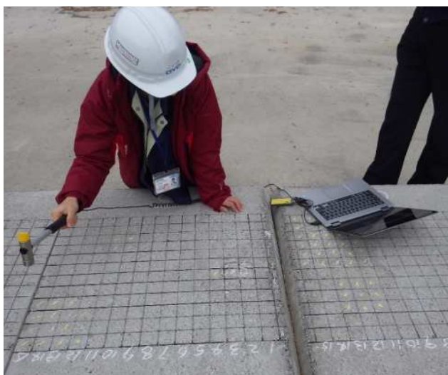
写真2. AI打音ハンマーによる測定実施状況
