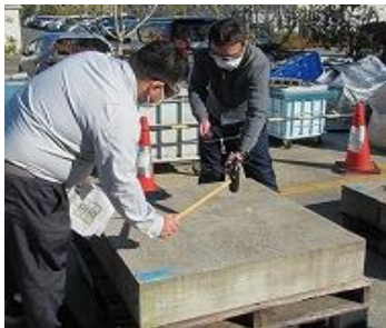
打音集音状況
