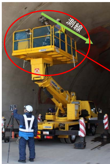
トンネル点検車
