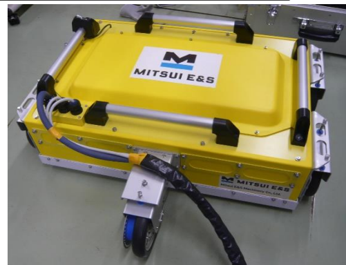
使用計測機器 MPLALレーダ背面空洞用レーダ装置 (探査幅60cmタイプ)
