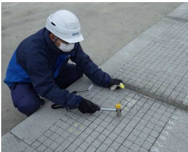
写真1. 技術者による打音検査実施状況
