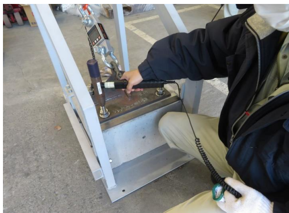
写真-3 測定状況(大ハンマ軸方向打撃)
