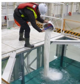
写真-11 濁度材投入状況
