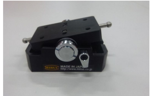
写真-2 傾斜架台
