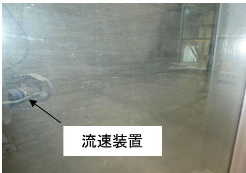
写真-9 流速装置
