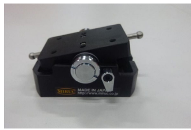
写真-3 傾斜架台
