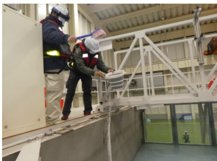
写真-11 濁度材投入状況
