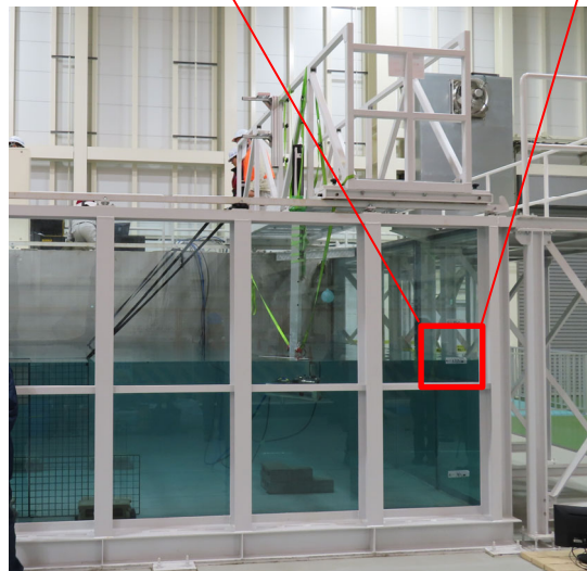
写真-1 小水槽(満水時 H=1.20m)
