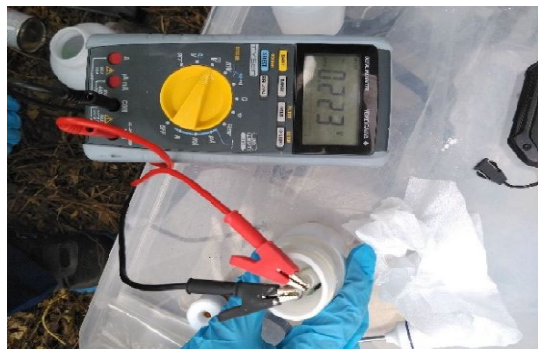
写真-5 電位差の測定状況
