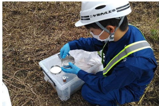
写真-2 600 \mu mふるいにて粒度調整
