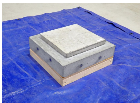
写真-1 検証試験体(表面計測)
