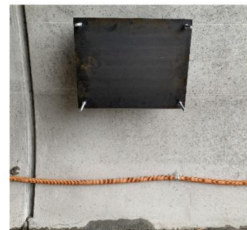
照明用供試体
