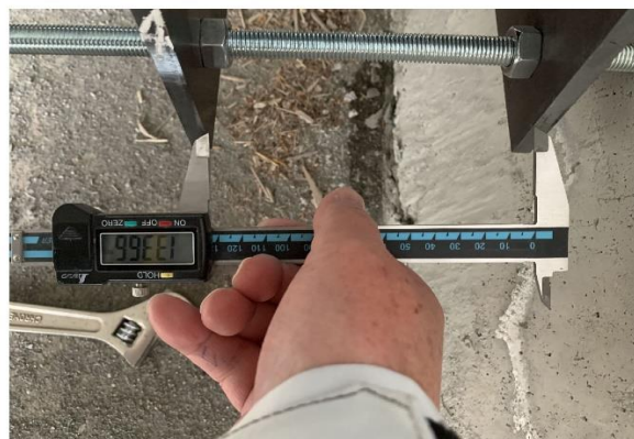
ポイント4 ノギスで内寸法を測り固定し、上下反転して表示した
