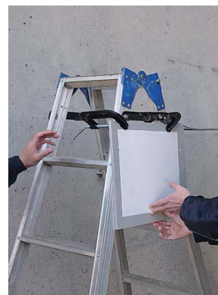
距離計評価用ターゲット (1mmプレート追加)
