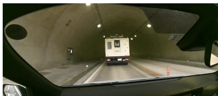
計測状況(坑内)(追尾車から撮影)時速60km/hr
