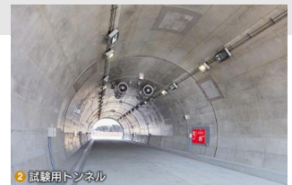
2 試験用トンネル 背面空洞を有するトンネル実験施設の例 （福島ロボットテストフィールドホーム ページより引用）
