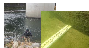
潜水調査による河床洗掘の把握
