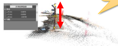
図16-1 点群からの寸法計測方法
