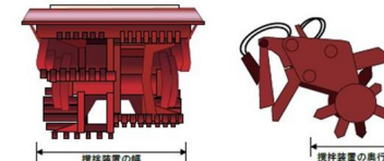
幅の採寸位置の例(自走式スタビライザ)
