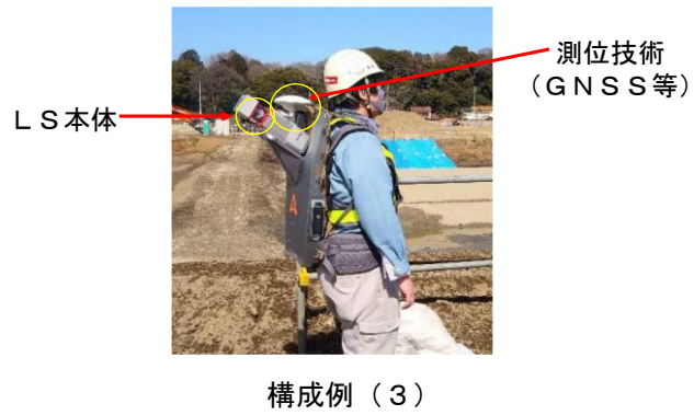
図2-7 地上移動体搭載型LSの構成例
